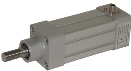
I cilindri con trasduttore di posizione magnetostrettivo della serie POTM sono attuatori pneumatici a norma ISO 15552 (fatta eccezione per l'alesaggio 50) equipaggiati con un trasduttore a tecnologia magnetostrettiva integrato. Tale dispositivo è in grado di rilevare continuamente la posizione del pistone durante il suo movimento con una precisione della misura superiore a quelli con tecnologia potenziometrica della serie POT.
